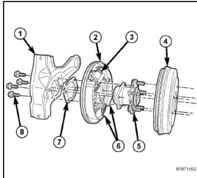
后鼓式制动器也用作驻车制动系统的一部分。 [\(参见05 - 制动器/驻车制动器 - 说明\)](#)
